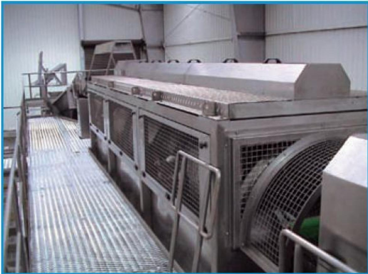
Барабанная моечная машина предназначена для удаления небольших камней, а также общего промывания продуктов. Промывание может осуществляться в условиях полного или частичного погружения продуктов в воду. Машина оснащена функцией самоочистки благодаря встроенной разбрызгивающей системе или поворотному скребку. Отличается деликатным обращением с продуктами.
